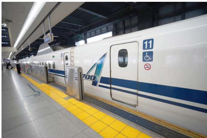
11号車のみドア幅が広い
